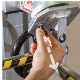
Pociągając za hak przestawia się HW I.MA z pozycji 1 na 2. By pulling the hook, the position of HW I.MA switches from 1 to 2.
