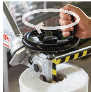
Obracając pokrętko mocuje się belę, przeznaczoną do przemieszczenia. Turn the knob to position the roll to be moved.
